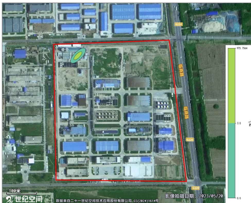
图 5.4-6a \text{COD}_{\text{Mn}} 超标范围示意图 (100d)
