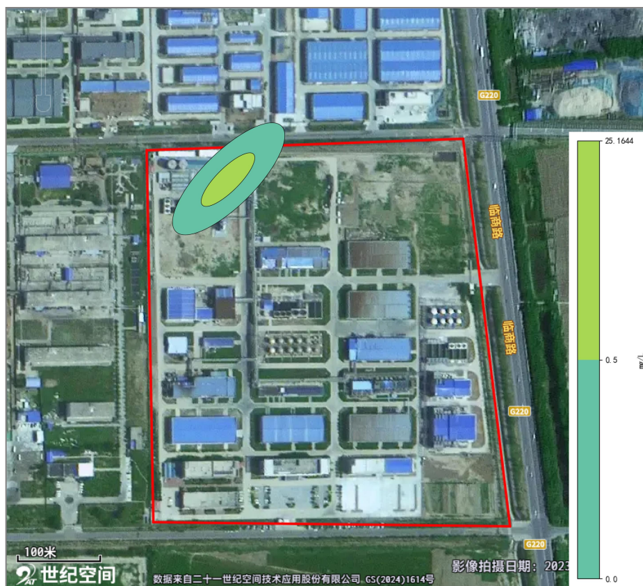
图 5.4-6e 氨氮超标范围示意图（1000d）
